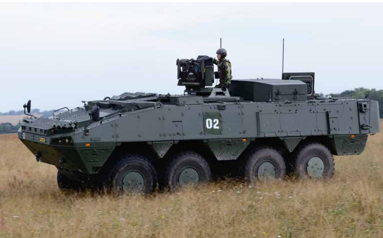
Den svenska vagnen har ett kraftfullt minskydd och åttahjulsdraft.
